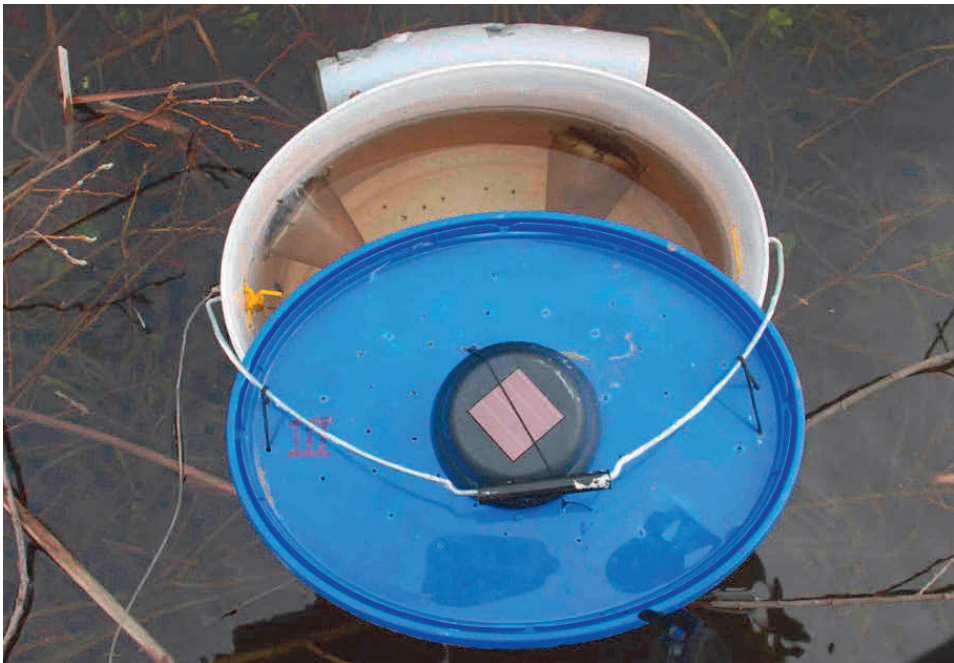
Abb. 17: ORTMANN-Eimerreuse mit zusätzlich angebrachter Solarleuchte, a) von oben, b) Innenseite des Deckels einer Eimerreuse mit Solarleuchte. Fotos: C. Göcking
