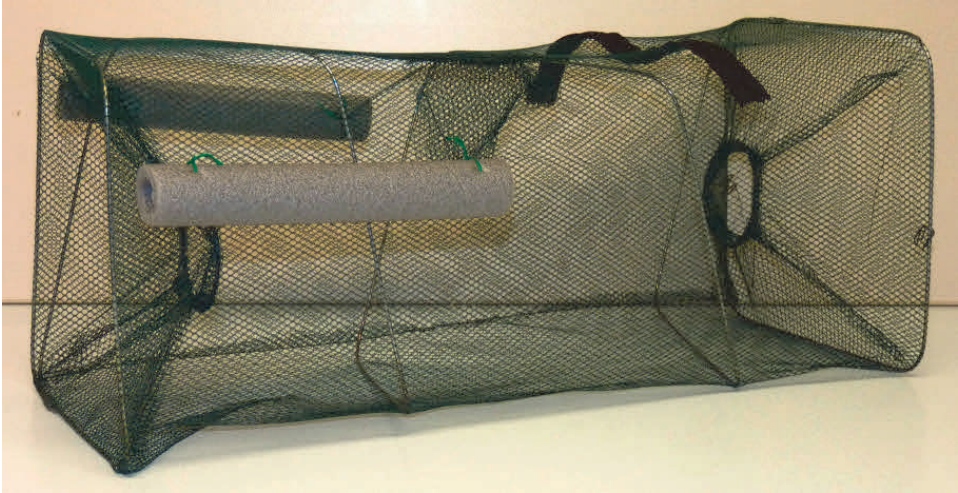
Abb. 7: Für den Molchfang ungeeignete Kleinfischreuse mit einem viel zu großen Durchmesser (7 cm) der inneren Trichteröffnung. Nachträglich wurden die Trichteröffnungen in das Falleninnere eingezogen und Schwimmhilfen angebracht. Foto: A. Kronshage
